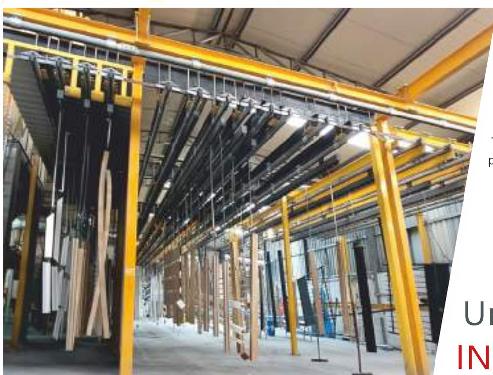
Traitement par sablage, métallisation, ou profiles acier galvanisés. Thermolaquage par plastification haute protection, par poudrage électrostatique au polyester sans TGIC (120 microns minimum) et polymérisation par cuisson au four à 200°C.
